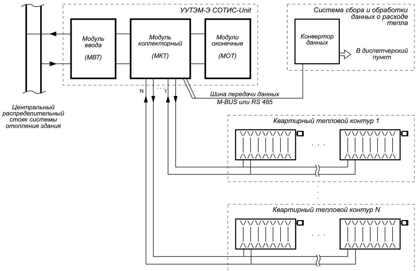
Конструктивно узел УУТЭМ-Э представляет собой несколько модулей СОТИС-Unit: модуль ввода (МВТ), коллекторный модуль (МКТ), оконечные (МОТ) и сервисные (МСТ) модули, последовательно соединенные между собой с помощью соединительных элементов, таких как ниппели, футорки, соединители с накидной гайкой «американка» и пр. Выбор конкретных модулей, соединительных элементов и их комбинации зависит от технических характеристик и функций узла, заданных проектом.
