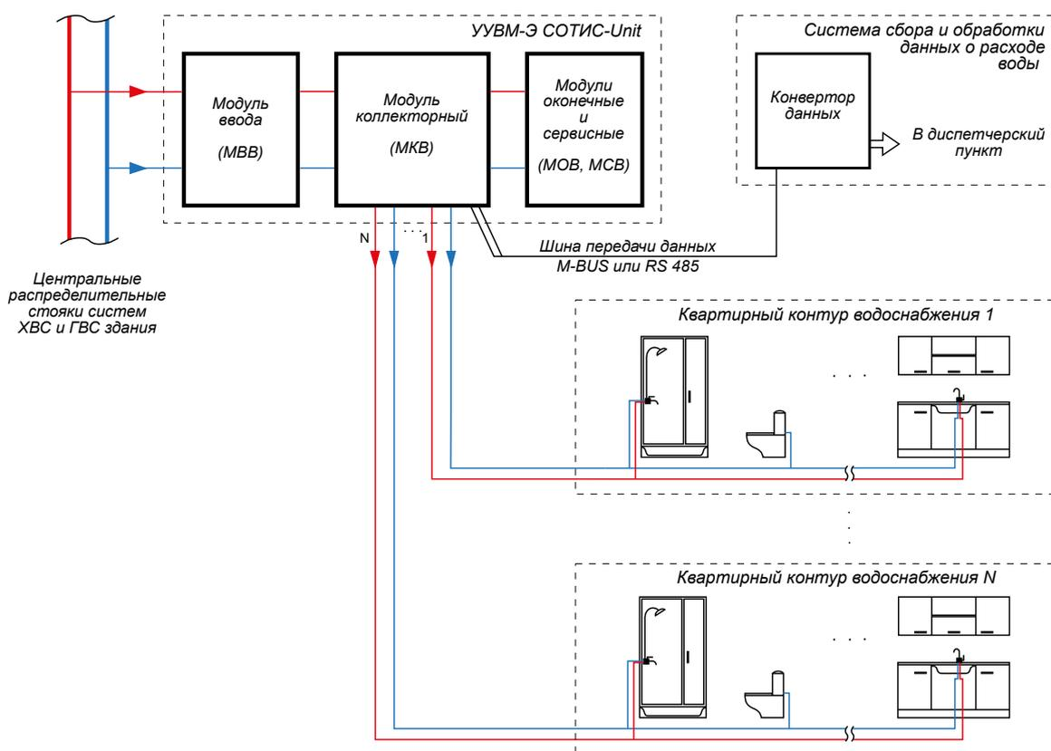
Конструктивно узел УУВМ-Э представляет собой несколько модулей СОТИС-Unit: модуль ввода (МВВ), коллекторный модуль (МКВ), оконечные (МОВ) и сервисные (МСВ) модули, последовательно соединенные между собой с помощью соединительных элементов, таких как ниппели, футорки, соединители с накидной гайкой «американка» и пр. Выбор конкретных модулей, соединительных элементов и их комбинации зависит от технических характеристик и функций узла, заданных проектом.
